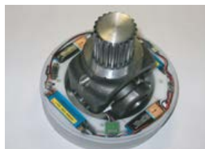
Hệ thống đo từ xa dùng cho cảm biến tốc độ quay
