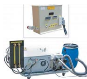
Giá thử nghiệm động cơ đốt trong (xăng/diezen)
