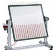
Áp kế đa ống hiển thị đồ họa phân phối áp suất
